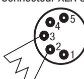
Pour utiliser des appareils DMX munis de connecteurs 3 points avec des appareils DMX munis de connecteurs 5 points, il faut utiliser un adaptateur.
